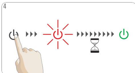
4 Démarrez la machine. Le bouton Marche/Arrêt commence à clignoter en rouge quand la machine se met en température pendant 40 secondes environ. Ensuite, le bouton marche/arrêt s'éclaire en vert. La machine est opérationnelle.
