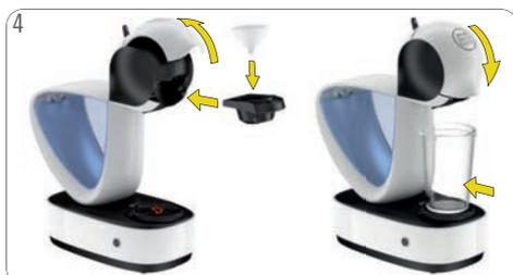
Ouvrez la poignée de verrouillage. Placez l'accessoire de rinçage dans le porte-capsule. Insérez le porte-capsule dans la machine. Fermez la poignée de blocage. Placez un grand récipient vide sous la sortie café.
