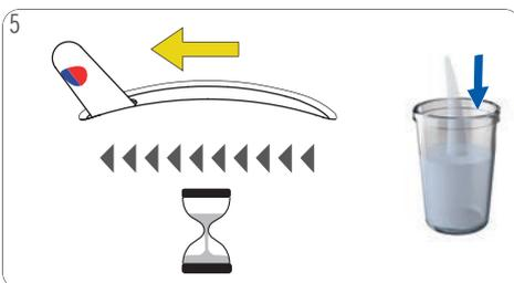
5 Poussez le levier de sélection en position « COLD ». Le rinçage démarre.
