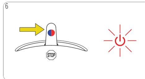
6 Au bout de 60 secondes environ, poussez le levier de sélection en position « STOP ». La machine arrête le rinçage. Le bouton marche/arrêt clignote en rouge pendant 5 secondes environ.
