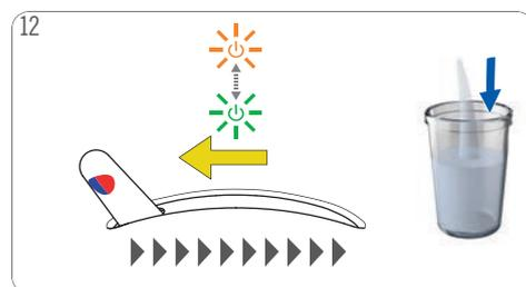
Poussez le levier de sélection en position « COLD ». Le rinçage démarre. Le bouton marche/arrêt clignote en alternance en vert / orange.
