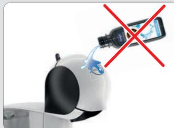
Évitez que le liquide détartrant entre en contact avec une partie quelconque de la machine.
