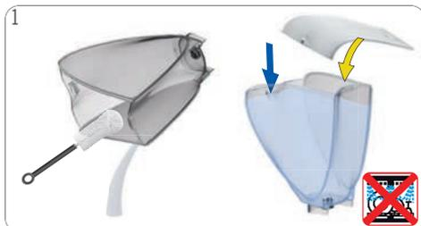
Rincez et nettoyez le réservoir d'Eau. Utilisez une brosse propre utilisable pour les produits alimentaires et un détergent au besoin. Remplissez-le de nouveau d'eau potable fraîche et introduisez-le dans la machine. Le réservoir d'eau n'est pas conçu pour le lave-vaisselle.
