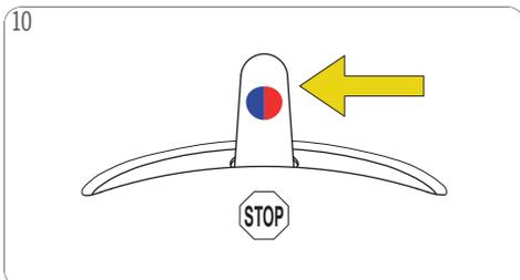
Restez à côté de la machine durant la préparation ! Une fois le niveau désiré atteint, poussez le levier de sélection en position « STOP ». La machine arrête la préparation.
