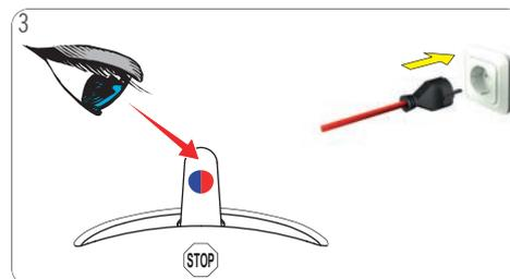
3 Assurez-vous que le levier de sélection est en position « STOP ». Veillez à utiliser la tension prescrite au chapitre 2. « PRÉSENTATION DE LA MACHINE » à la page 5. Raccordez le câble d'alimentation à la prise de courant secteur.
