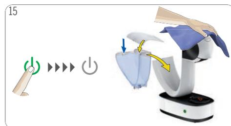
Éteignez la machine. Versez de l'Eau potable fraîche dans le réservoir. Réintroduisez celui-ci dans la machine. Nettoyez la machine avec un chiffon doux humide. Essuyez-la avec un chiffon doux sec.
