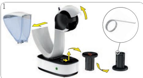
Assurez-vous que le bac d'égouttage est vide. Retirez le réservoir d'eau. Ouvrez la poignée de verrouillage. Retirez et inclinez le bac récolte-gouttes pour le vider. Sortez l'aiguille de nettoyage. **Conservez l'aiguille hors de portée des enfants !**
