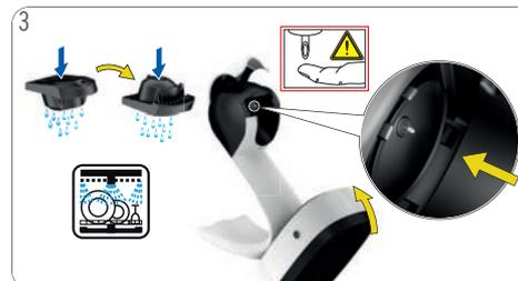
Nettoyez avec un détergent liquide et de l'eau potable fraîche les deux côtés du porte-capsule. Ou lavez-le dans un lave-vaisselle. Essayez-le ensuite. Nettoyer la tête de la machine autour de l'injecteur à l'aide d'un chiffon doux humide.
