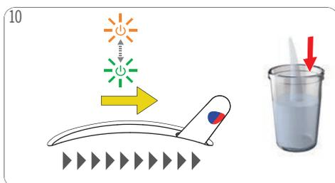
Poussez le levier de sélection en position « HOT ». Le rinçage démarre.
