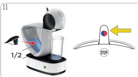
Contrôlez visuellement que le réservoir est à moitié plein. Poussez le bouton de sélection en position « STOP ».
