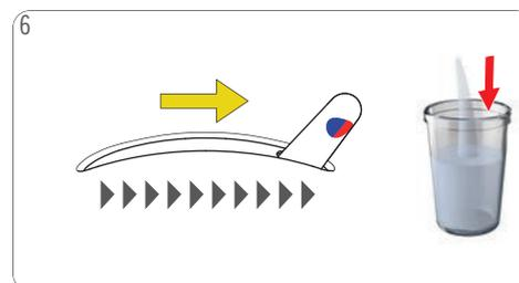
6 Poussez le levier de sélection en position « HOT ». Le détartrage démarre.
