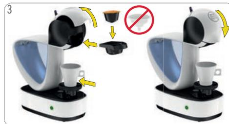
Placez une tasse de taille appropriée sur le bac. Voir 3. «EXEMPLES DE BOISSONS» ou l'emballage. Ouvrez la poignée de verrouillage. Sortez le porte-capsule. Assurez-vous que l'outil de rinçage n'est pas à l'intérieur. Insérez une capsule dans le porte-capsule. Réintroduisez celui-ci dans la machine. Fermez la poignée de blocage.
