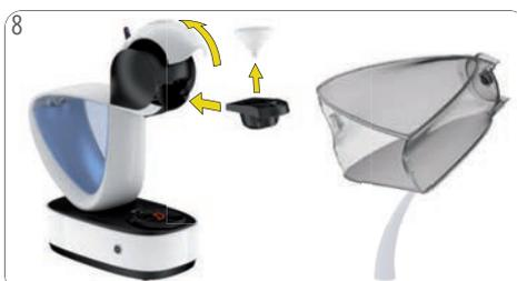
Ouvrez la poignée de verrouillage. Sortez le porte-capsule. Enlevez l'accessoire de rinçage. Réinsérez le porte-capsule. Si le réservoir contient de l'eau, videz-le.
