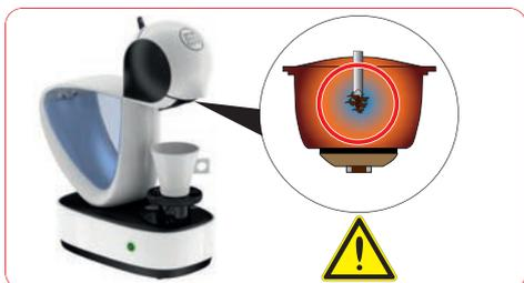
Aucun liquide ne sort : l'injecteur est peut-être bloqué ou la pression est trop faible.
