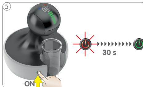
Allumez la machine. Pendant le préchauffage, le bouton marche/arrêt se met à clignoter en rouge. Après env. 30 secondes, la lumière du bouton marche/arrêt devient verte. La machine est opérationnelle.
