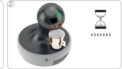
Le mélange de café s'écoule hors de la partie supérieure du logement de capsule. Attendez la fin du processus. C'est le cas lorsque la machine ne fait plus de bruit.
