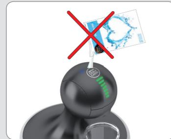
Évitez que le liquide détartrant entre en contact avec une partie quelconque de la machine.
