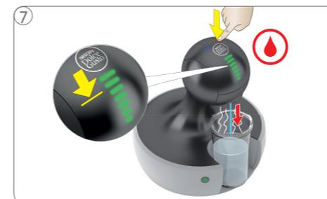
Effleurez le voyant Eau chaude. Les témoins lumineux commencent le compte à rebours. La machine se détartre en mode marche/arrêt pendant 2 min. environ. Attendez la fin de l'extraction.
