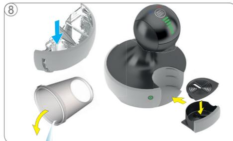
Videz le récipient Remplissez le réservoir d'eau potable fraîche. Réintroduisez-le dans la machine. Placez la grille d'égouttage sur le bac d'égouttage. Insérez le bac d'égouttage dans la position souhaitée.
