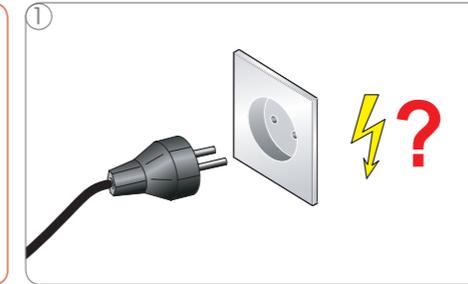
Vérifiez si la fiche de courant est correctement branchée sur la prise. Si oui, vérifiez l'alimentation électrique.
