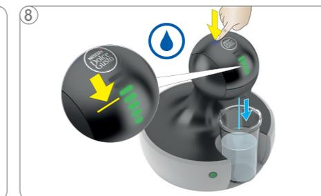
Effleurez le voyant Eau froide. Les témoins lumineux commencent le compte à rebours. La machine se détartre en mode marche/arrêt pendant 2 min. environ.
