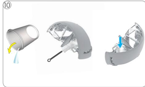
Videz et nettoyez le récipient. Rincez et nettoyez le réservoir d'eau. Utilisez une brosse propre utilisable pour les produits alimentaires et un détergent au besoin. Remplissez ensuite le réservoir d'eau potable fraîche et réintroduisez-le dans la machine.
