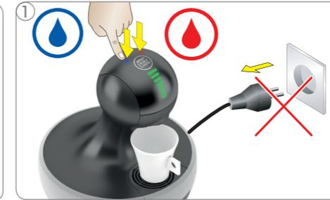
**La machine doit toujours être bien en place et stable!** Pour arrêter la préparation, effleurez de nouveau le voyant eau chaude/froide. Ne débranchez pas la machine. Elle évacue la pression.
