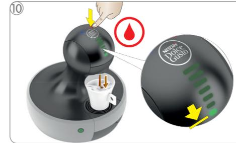
10 Effleurez le voyant Eau chaude ou froide selon la boisson souhaitée. La préparation de la boisson commence. Restez à côté de la machine pendant toute l'opération. L'éclairage des témoins lumineux disparaît progressivement. La machine arrête la préparation.
