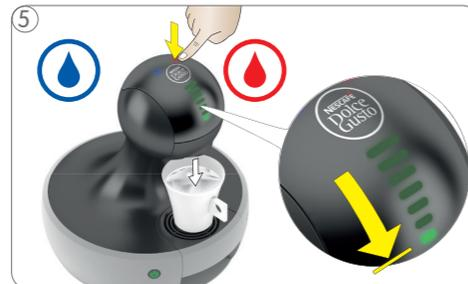
5 Effleurez le voyant Eau chaude (ou froide selon la boisson). La préparation de la boisson commence. Restez à côté la machine durant la préparation! L'éclairage des témoins lumineux disparaît progressivement. La machine arrête la préparation en mode automatique.
