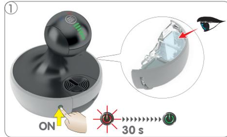
1 Vérifiez si le réservoir contient assez d'eau. Allumez la machine. Pendant le préchauffage, le bouton marche/arrêt se met à clignoter en rouge. Au bout d'env. 30 secondes, le bouton marche/arrêt émet une lumière verte continue et la machine est opérationnelle.
