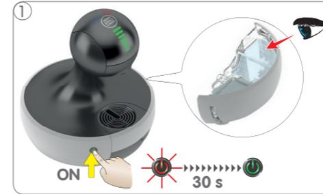
Vérifiez si le réservoir d'eau contient assez d'eau fraîche. Allumez la machine. Pendant le préchauffage, le bouton marche/arrêt se met à clignoter en rouge. Au bout d'env. 30 secondes, le bouton marche/arrêt émet une lumière verte continue et la machine est opérationnelle.
