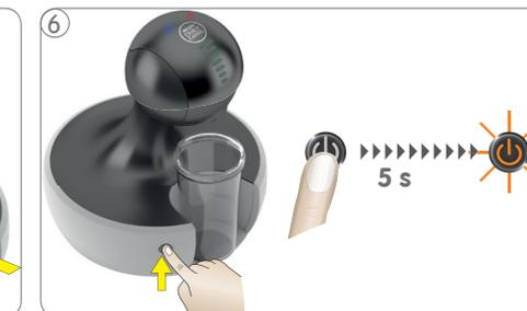
Appuyez sur le bouton marche/arrêt pendant 5 secondes au moins. Le bouton marche/arrêt clignote en alternance en vert / orange et la machine se règle en mode détartage.
