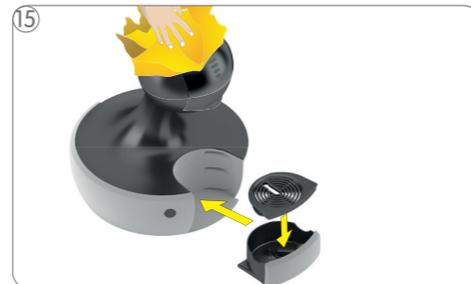
Nettoyez la machine avec un chiffon doux humide. Essuyez-la avec un chiffon doux sec. Placez la grille d'égouttage sur le bac d'égouttage. Puis insérez le bac d'égouttage à la position souhaitée.
