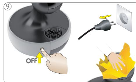
Eteignez la machine. Débranchez la fiche de courant. Nettoyez la machine avec un chiffon doux humide. Essuyez-la avec un chiffon doux sec.
