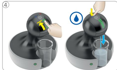
Commencez par rincer avec de l'eau froide. Réglez les témoins lumineux sur le niveau max. Effleurez le voyant Eau froide. Le rinçage démarre.
