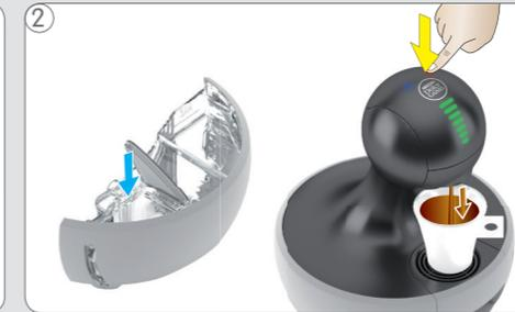
Vérifiez s'il y a de l'eau dans le réservoir: s'il n'y en a pas, remplissez-le d'eau potable fraîche et effleurez le voyant Eau chaude/froide pour continuer la préparation. Si le réservoir est plein, procédez comme suit.
