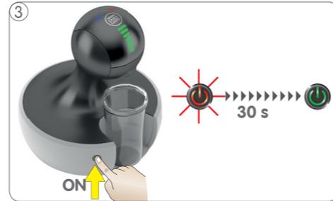
Allumez la machine. Pendant le préchauffage, le bouton marche/arrêt se met à clignoter en rouge. Au bout d'env. 30 secondes, le bouton marche/arrêt émet une lumière verte continue et la machine est opérationnelle.
