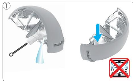
Rincez et nettoyez le réservoir d'eau. Utilisez une brosse propre utilisable pour les produits alimentaires et un détergent au besoin. Remplissez-le de nouveau d'eau potable fraîche et introduisez-le dans la machine. Le réservoir d'eau n'est pas conçu pour le lave-vaisselle.
