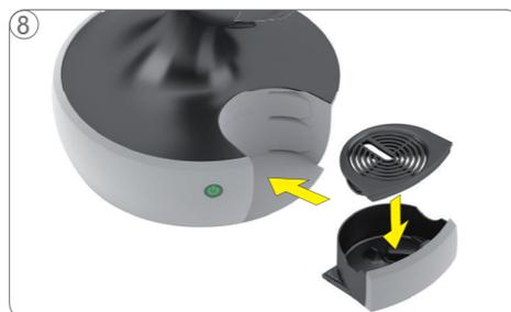
Placez la grille d'égouttage sur le bac d'égouttage. Insérez le bac d'égouttage dans la position souhaitée. Si le réservoir contient de l'eau, videz-le.
