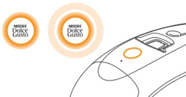
**Le bouton de démarrage émet une lumière jaune continue lorsque la machine est prête ou une lumière orange atténuée pendant la préparation d'une boisson. La machine doit être détartrée !**
